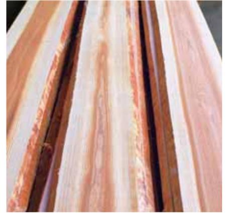
しかし同じ乾燥でも、この2種はそれぞれ違った特性で乾燥しにくい材です。杉は水分の保持力が強く、なかなか乾燥させにくい木ですが、カラマツは乾燥することによって癖が出て歪みやすく、使い方が難しい木なのです。樹木はねじれながら生長しますが、カラマツは特にこのねじれが強いのです。原木ではまっすぐに見え、断面の年輪は均等に見え、製材して板目が通っていても、育ってきた筋はねじれているので乾燥すると歪みが出てきます。カラマツの乾燥材を見ると、ひびや割れ目が斜めに入るのでこのことが良く解ります。和紙をこよりにしたり、荒縄をより合わせると丈夫になるように、カラマツは大きな縄のような強さを発揮します。
